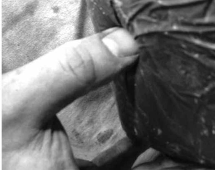
Figur B3: Bilden visar hur en tumme trycks in i betong som förvaras i en polyetylenpåse [22]
