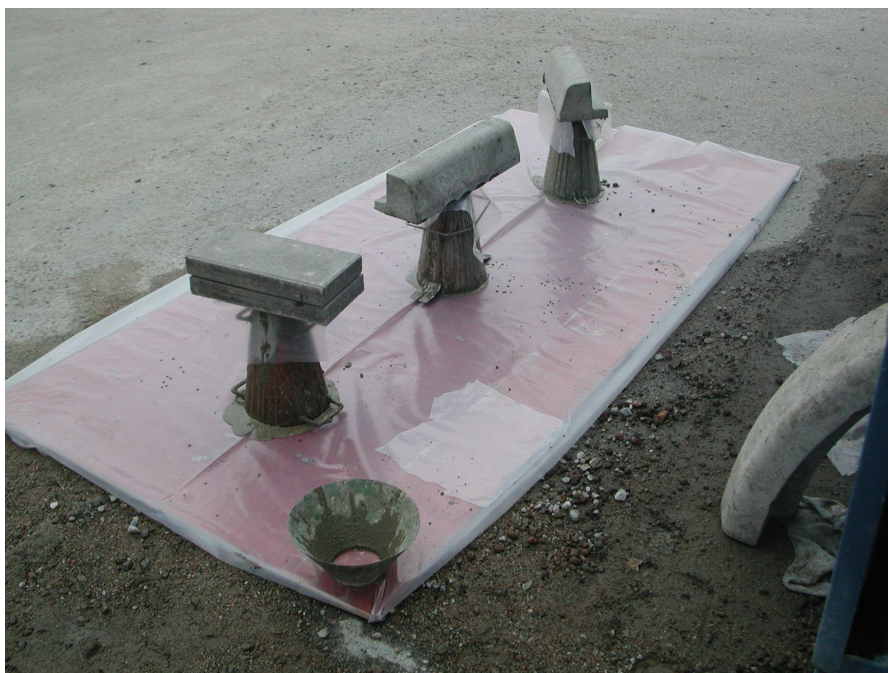
Figur B2: Exempel på försöksuppställning för utvärdering av vilande betongers minskande flytsättningsmått [21]
